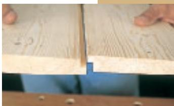
2. Assemblage à recouvrement. C'est un assemblage à mi-bois, les deux pièces étant entaillées d'une feuillure de la moitié de leur épaisseur.
