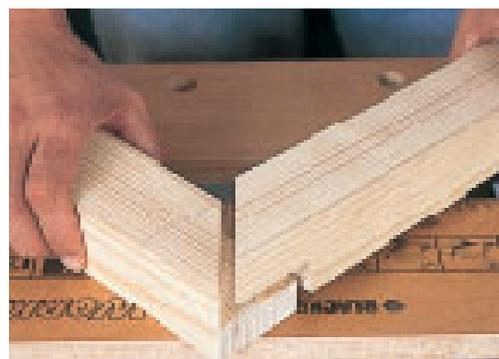
**Une variante du mi-bois en angle : l'assemblage à mi-bois avec "flottage d'onglet". Il n'est pas plus difficile à réaliser et son aspect est plus décoratif.**
