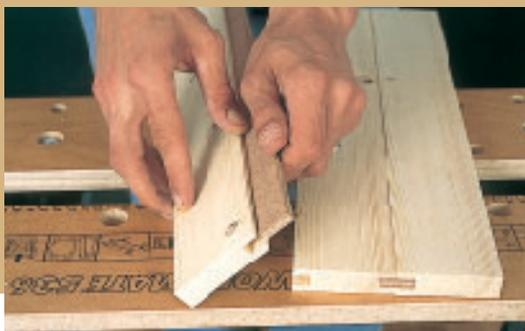
3. Assemblage à fausse languette. Une lamelle de contreplaqué (la fausse languette) est emboîtée dans des rainures réalisées dans les deux pièces à assembler. Ces rainures ont la même épaisseur que la fausse languette, le plus souvent 5 ou 8 mm. Assez simple à exécuter avec une défonceuse, cet assemblage permet de réaliser des panneaux en bois massif à partir de planches. Les fausses languettes donnent une grande résistance à l'ensemble.
