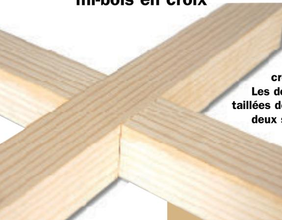
C'est l'assemblage en croix le plus classique. Les deux pièces de bois sont taillées de façon identique : deux sciages verticaux et dégagement de l'entaille au ciseau à bois.
