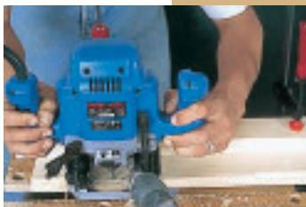
1. Ce sont les assemblages de type parquet, à rainure et languette. Ils sont nécessairement réalisés à la machine, à la toupie d'atelier ou à la défonceuse. La défonceuse est guidée par une règle fixée sur la pièce à entailler.
