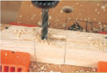
9. ... ou même à la perceuse, en perçant une série de trous tangents, de la largeur de la mortaise. Il est très difficile d'aligner les trous si l'on ne dispose pas d'un support vertical de perceuse.
