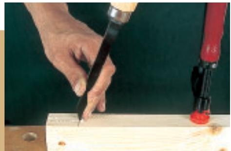
C'est un assemblage à tenon et mortaise simplifié, réalisable pour les assemblages en angle ou en bout. L'une des pièces est taillée avec un tenon, l'autre avec une fourche, que l'on réalise par deux sciages pour ses joues et par un dégagement au bédane.
