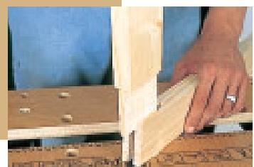
3. Utilisé pour réaliser des châssis, cet assemblage doit être renforcé par des chevilles ou des vis.
